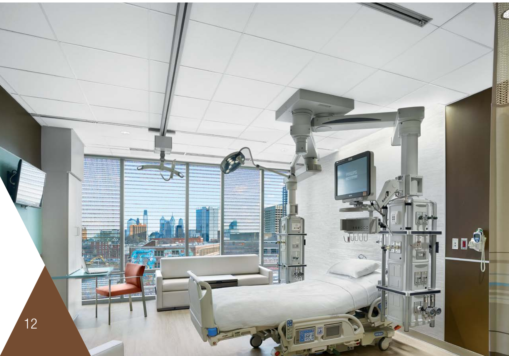
▼ Plafones Ultima® Health Zone™ con sistema de suspensión Silhouette de 9/16" con ranura de 1/4"
