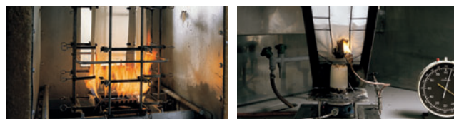
Trevira CS Bioactive recibe la distinción de difícilmente inflamable en las pruebas contra incendios más importantes a nivel internacional. Entre ellos se encuentra el estricto test según la norma DIN 4102, clase B1, así como el test contra incendios más riguroso mundialmente llevado a cabo en Francia con el "Brûleur électrique".
